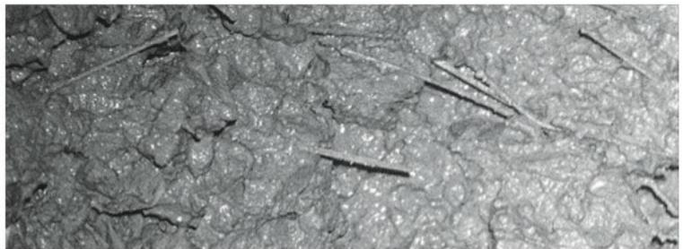
A la différence de l'armature traditionnelle les fibres augmentent la résistance à traction par flexion du béton et se positionnent dans toutes les directions du dallage et diminuent le risque de fissuration. Avec les macro Structural Fiber DS 30 e Fibercem 1,50-0,80/60 -2/44 il est possible de:
