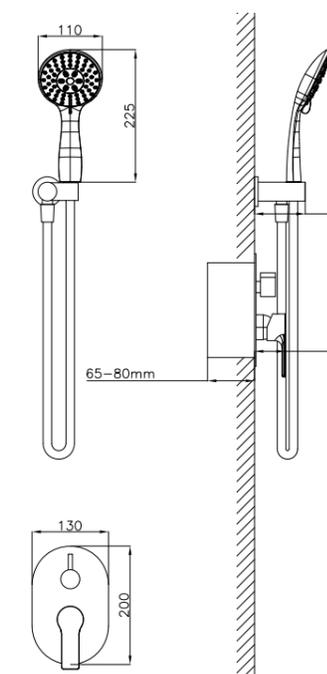
Conjunto de ducha monomando empotrado de 2 vías. Rociador redondo de Acero Inox.S304 de 25cm. Ultrafino y antical. Soporte de mango de ducha orientable, con salida de agua a pared. Flexo de PVC 1,5m. Mango de ducha redondo con 3 funciones. **Caja de registro incluida.** Profundidad para empotrar 65-80mm.
