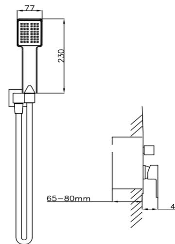
Conjunto de ducha monomando empotrado de 2 vías. Rociador cuadrado de Acero Inox.S304 de 25cm. Ultrafino y antical. Soporte de mango de ducha orientable, con salida de agua a pared. Flexo de PVC 1,5m. Mango de ducha cuadrado. **Caja de registro incluida.** Profundidad para empotrar 65-80mm.
