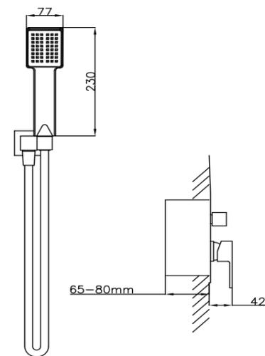
Conjunto de ducha monomando empotrado de 2 vías. Rociador cuadrado de Acero Inox.S304 de 25cm. Ultrafino y antical. Soporte de mango de ducha orientable, con salida de agua a pared. Flexo de PVC 1,5m. Mango de ducha cuadrado. **Caja de registro incluida.** Profundidad para empotrar 65-80mm.
